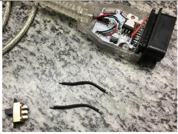
Anschließend brauch man 2 kleine Kabel die man bei dem Schalter auf die Mittlere Position lötet und auf eine der beiden äußeren.
