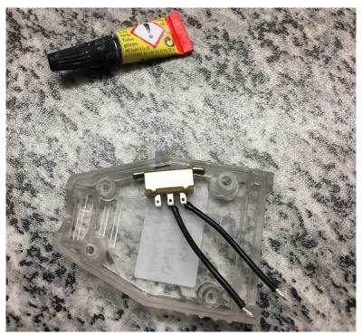
Danach Bohrt man ein kleines Loch in das Plastik damit der Schalter Hebel nach außen geht und klebt diesen am Gehäuse fest. Dabei sollte man auf die Position achten, damit man das Gehäuse später wieder zu bekommt.
